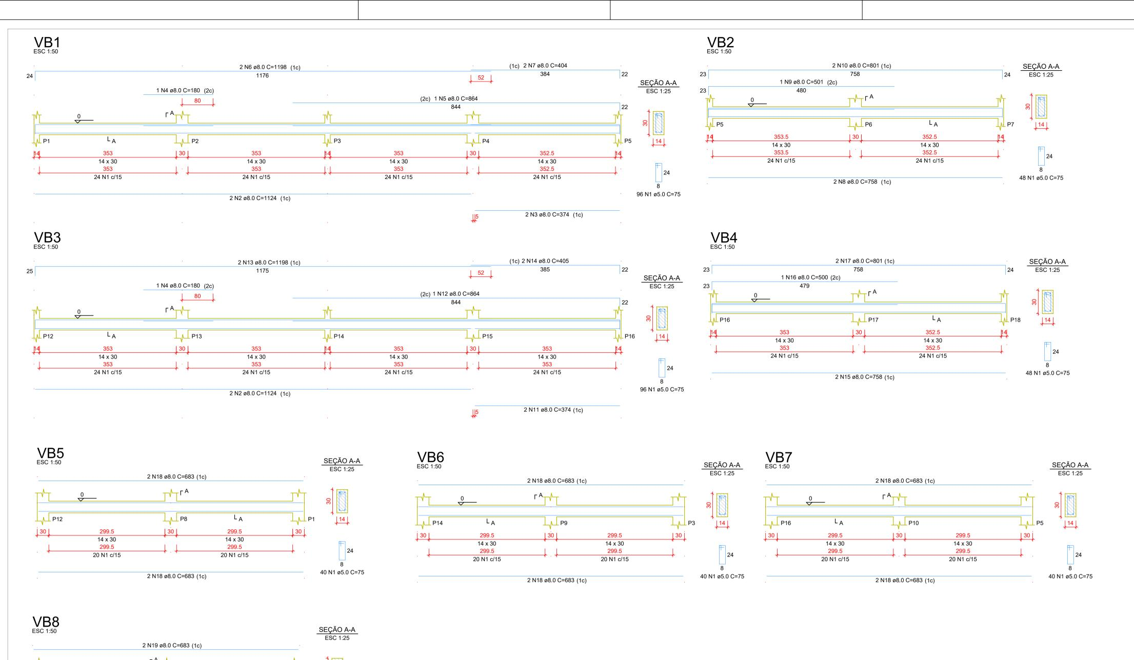
Detalhamento de Vigas Baldrames - 3 SALAS COM LAJE
